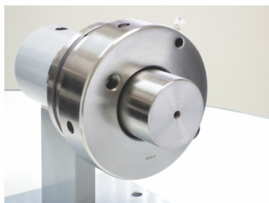
4 | Enroscar tuerca hidráulica en el manguito de fijación
