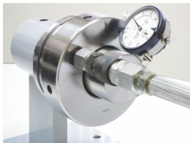
6 | Enganche de la manguera en la tuerca hidráulica para reducir el juego del rodamiento de acuerdo con el tamaño del rodamiento
