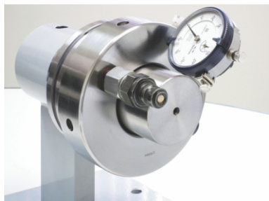
5 | Posicione el reloj comparador en la tuerca hidráulica
